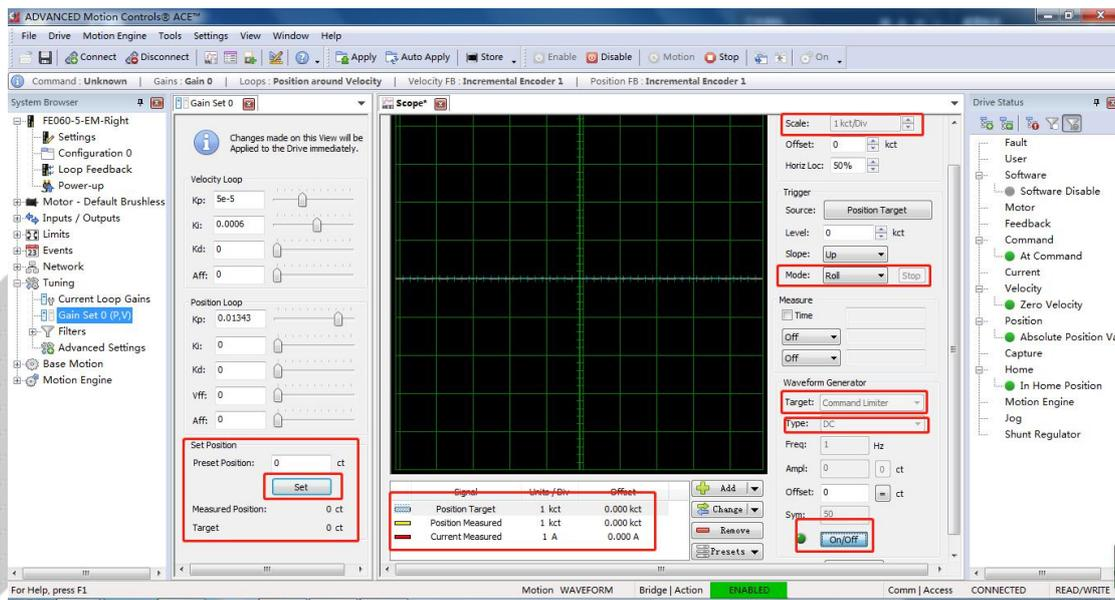
(1) 确保 Preset Position 的值为 0，点击“Set”按钮，将 Position Measured 和 Position Target 设为 0，注意此时的电机轴位置即为零点；
