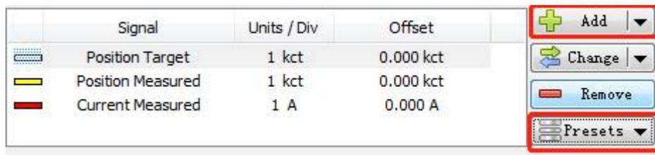
(3) Units/Div 为 Y 轴方向每一格的值，鼠标左键单击选中所需要更改的变量，通过 Scale 右边的上下箭头来调整此值，Position Target 和 Position Measured 的 Units/Div 必须保持一致；
