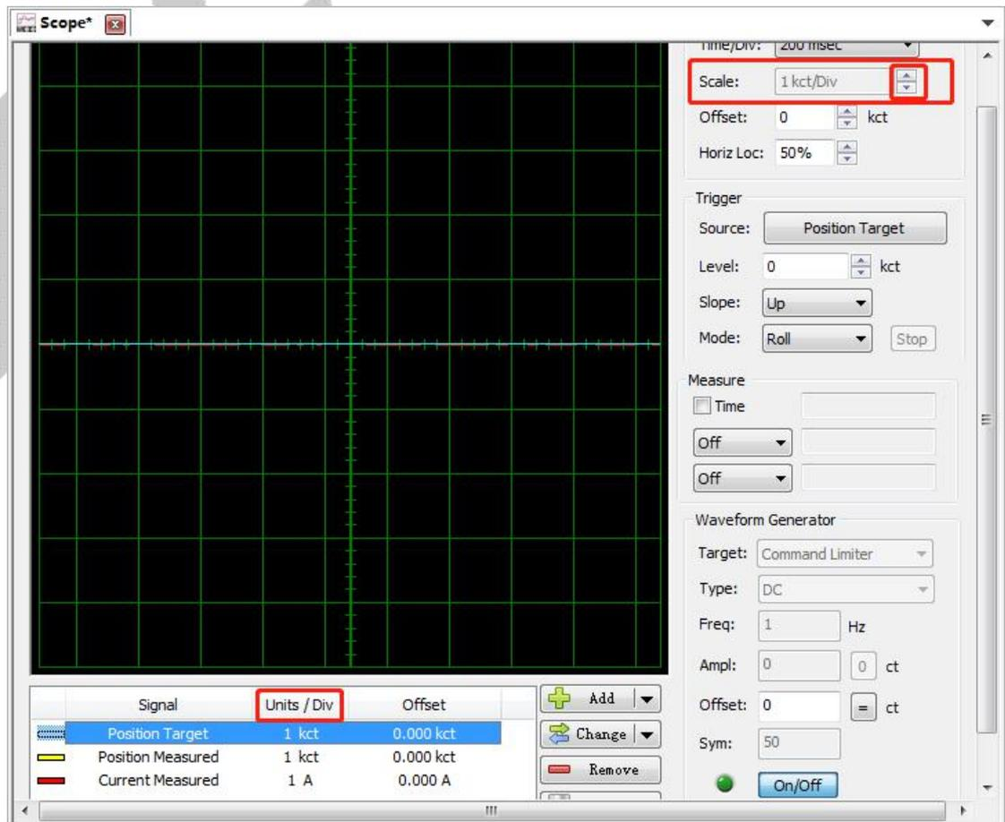
(4) Mode 选 “Roll”，即曲线为滚动显示；Target 选 “Command Limiter”，即为带有速度和加减速限制的位置模式，Type 选 “DC”；点击 “On/Off” 按钮，左边的圆形 LED 从红色变为绿色，即表示波形发生器功能激活；
