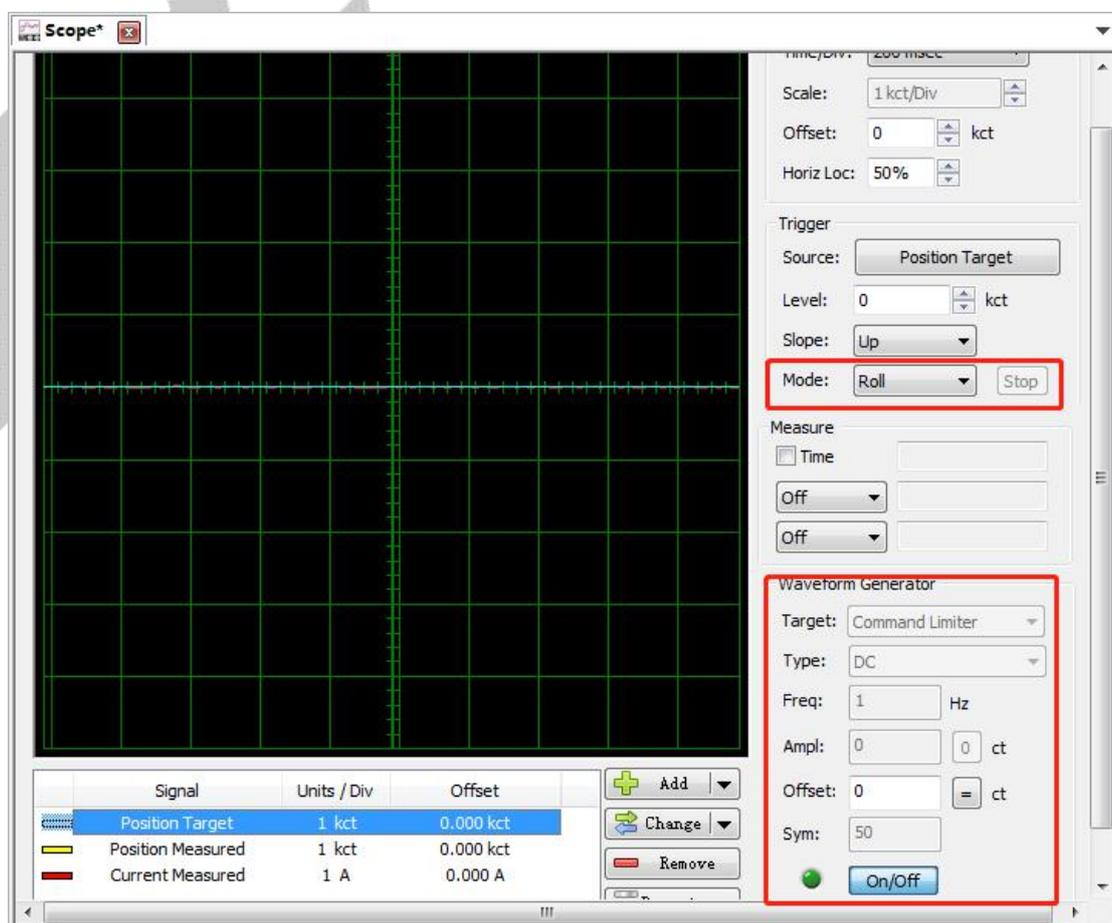
(5) 点击软件上部的“Enable”按钮，正常情况下，软件下部状态指示变为绿色，电机使能，在 Offset 中填入目标位置，点击“回车”键，目标值下发，电机转到目标位置；到此为止，位置测试完成；
