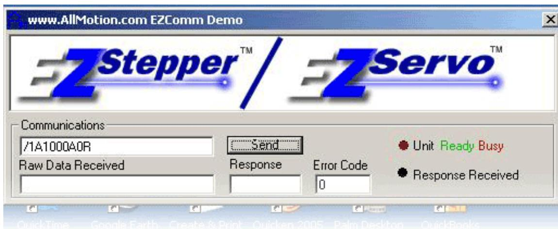
您可以[点击这里](#)下载一个示例VB应用程序。这个示例VB程序允许你设置一个通信端口，并输入一个命令字符串发送到EZStepper或EZServo。然后它将显示来自该单元响应。
