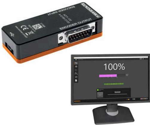
ATOM DX光栅系统与ADT (Advanced Diagnostic Tool — 高级诊断工具) ADTi-100和ADT View软件兼容，它们可为ATOM DX提供全面的实时光栅数据反馈，以协助完成要求更严苛的安装和诊断操作。直观的软件界面可用于：
