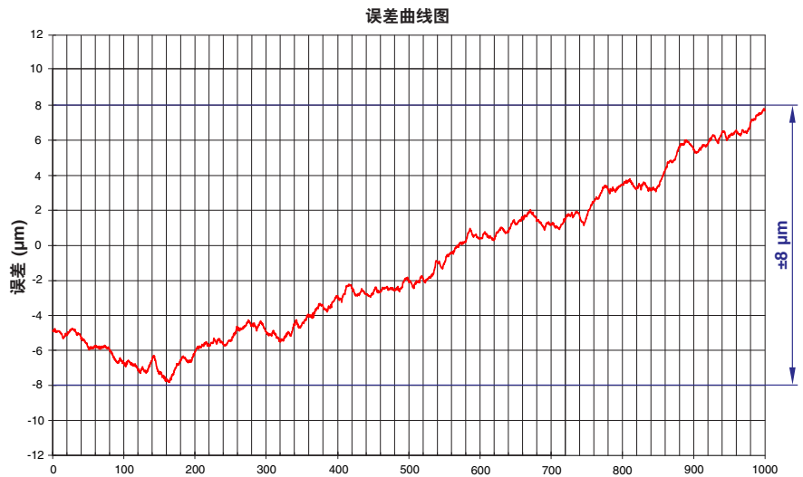
1000 mm长RTLA50栅尺精度测试结果示例
